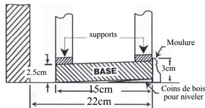
Avec les bases en place, vérifiez le niveau et ajustez avec des coins de bois pour niveler. Lorsque les supports sont en place, fixez la barre inférieure horizontale sur la base avec des clous ou des vis. Clouez ensuite la moulure sur le devant des bases.
